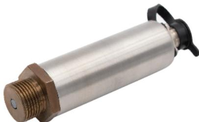
无管腔全齐平结构，优越的静态性能及动态响应能力，低噪声、高分辨率、高信噪比，可选带防光干扰，可选配双屏蔽互绞专用抗干扰电缆，适用于各种爆炸冲击波测量及动态压力测量。
